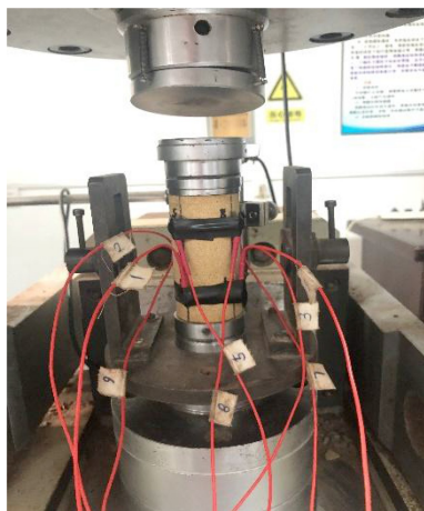
图 2 声发射传感器布置照片
