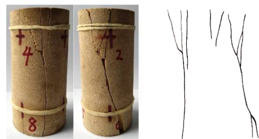
图 6 试件破坏形式
