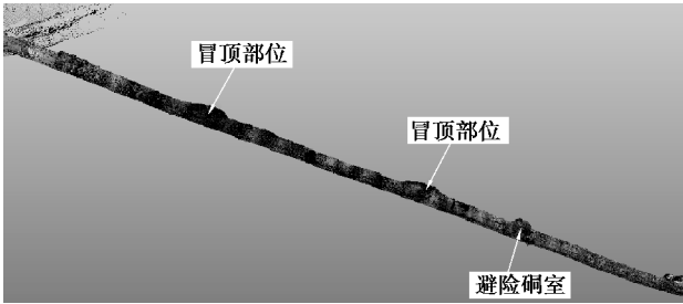
图 8 斜坡道三维激光扫描结果
