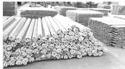
图2 玻璃纤维增强复合筋(GFRP筋)
