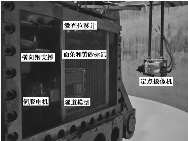
图 1 隧道开挖面离心试验模型 Fig. 1 Centrifuge model of tunnel face
