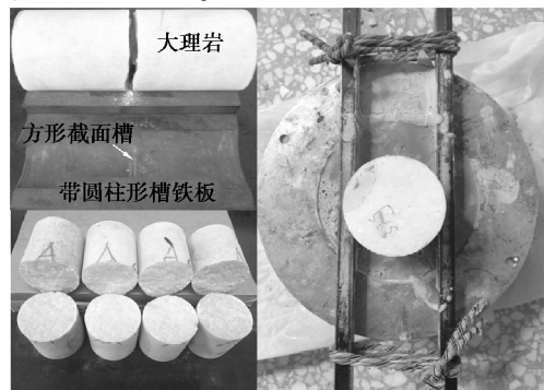
图1 制作模具(左上),节理试样(左下)和试样封装(右)
