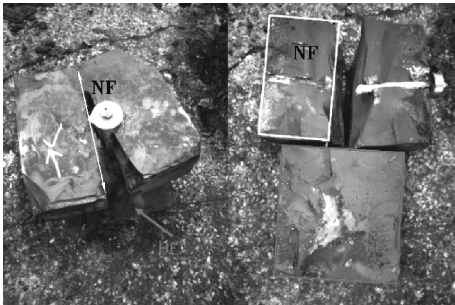
(a) 1#试样裂缝形态
