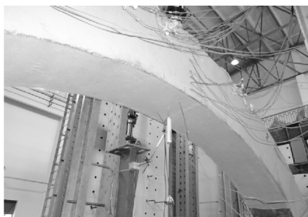
图6 芳纶纤维布补强试验梁
