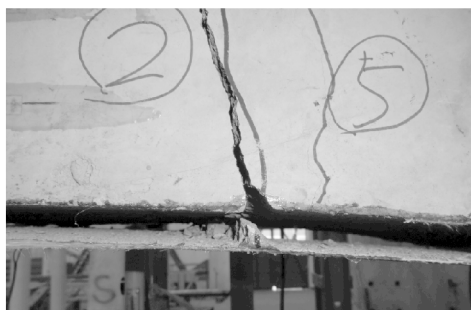
图7 芳纶纤维布补强试验梁破坏特征
