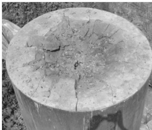
图 3 爆炸试验宏观破坏效果
