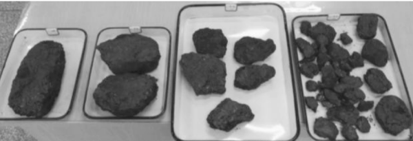
图 3 静水崩解试验岩样
