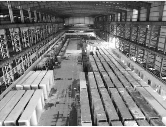
图 2 节段预制管廊图
