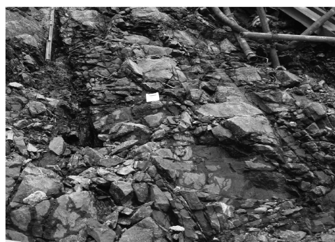
(b)右岸坝基980 m高程岩脉整体松弛
