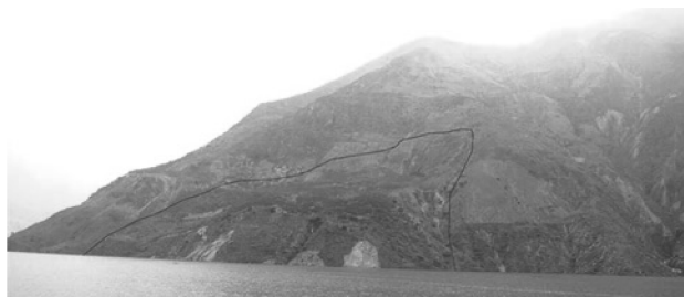
图6 雨林二组滑坡变形与垮塌照片
