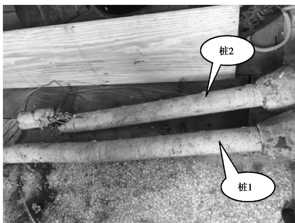
图 18 桩 1、桩 2 破坏形式对比
