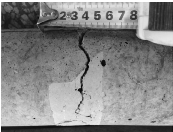
图 11 桩 1 桩身破坏最大裂缝处
