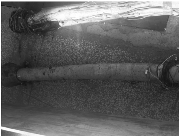
图 10 桩 1 破坏形式
