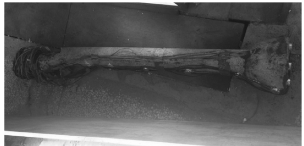
图 16 桩 2 破坏形式
