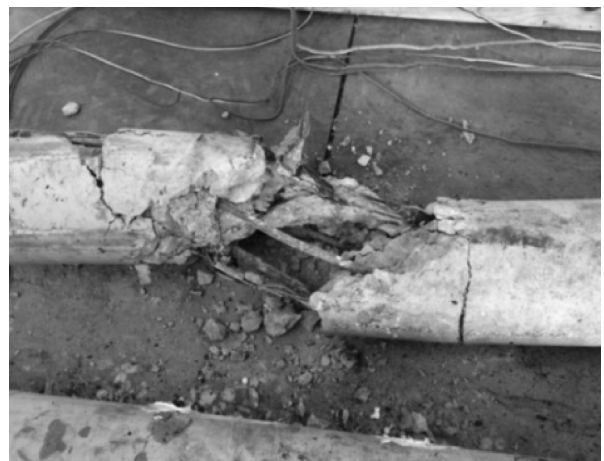
图 17 桩 2 桩头破坏最大裂缝处
