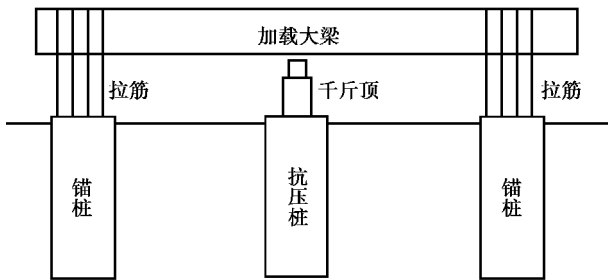
图2 单桩竖向抗压静载试验示意图
