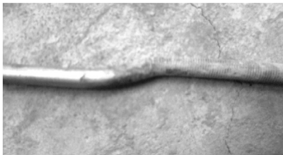
图 8 锚杆屈服剪切变形图
