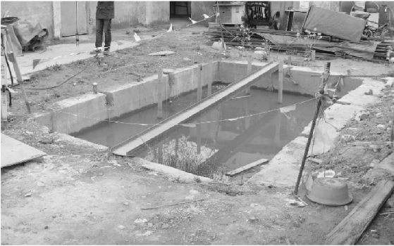
图 5 地下连续墙物理模型
