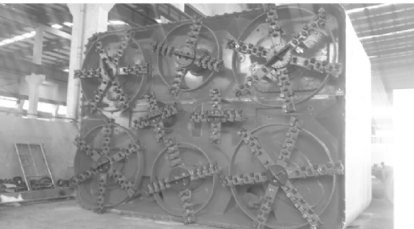
图 6 顶管机机头
