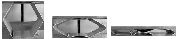
图 4 六边薄壁构件变形
