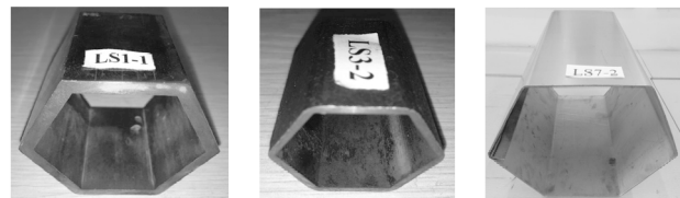
图3 六边薄壁构件实物
