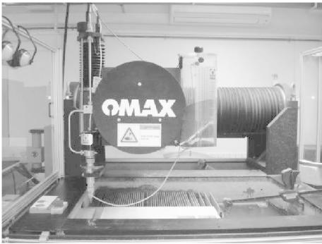
图 1 水刀切割机械设备 OMAX2626
