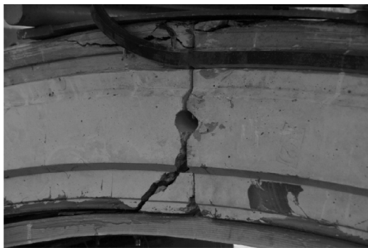
图 14 加固管片接头破坏形态
