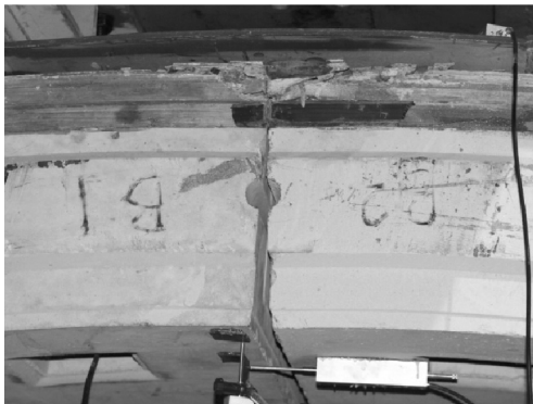
图 13 未加固管片接头破坏形态
