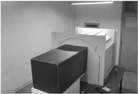
图 1 隧道照明环境模拟装置
