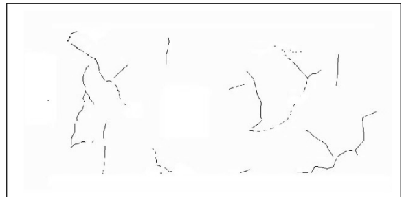
图 6 煤层下方 5 m 处水平切面照片、素描图
