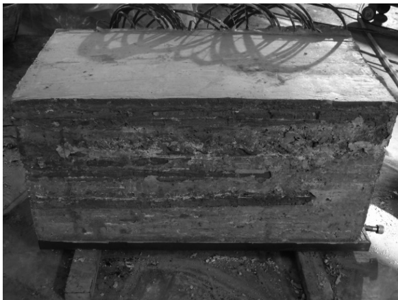
图 2 相似模拟模型实物图 Fig. 2 The similar simulation model
