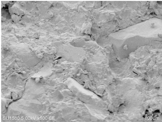
图 9 渗透试验前砂质泥岩试样
