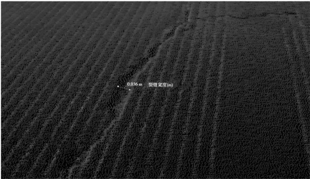
图 6 2009 年路面破损(0.036 m) Fig.6 Pavement surface distress in 2009
