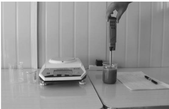
图 5 易溶盐含量测试图
